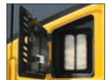
Filtro externo do ar condicionado
