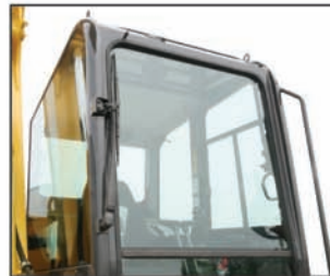
Limpador do vidro do pára-brisa com lavador do vidro incorporado
