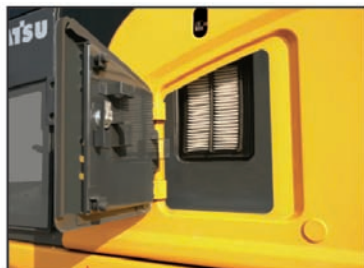
Filtro de óleo hidráulico (Elemento de concepção ambientalmente limpa Eco-White)
