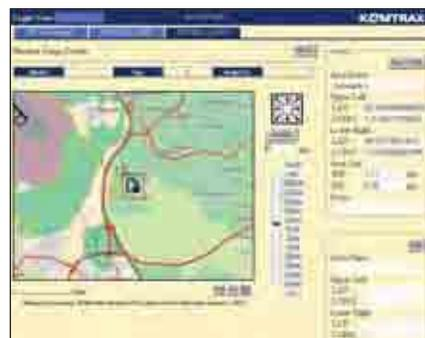
*Aumento de segurança – A função de “bloqueio do motor” permite programar quando a máquina pode ser colocada em funcionamento. E com as zonas geográficas defensivas, o KOMTRAX™ envia notificações sempre que a máquina desloca para fora da zona determinada.*
