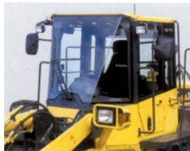
Um amplo vidro de superfície plana e sem colunas permite excelente visibilidade frontal. O braço do limpador cobre uma área extensa, possibilitando boa visibilidade mesmo em dias chuvosos. A área da cabina é a mais espaçosa da
