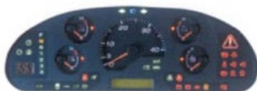
O monitor está localizado atrás do volante da direção e exibe diversas funções da máquina, entre elas intervalos de troca de fluidos/filtros e funções de exibição de memória de dados para diagnóstico de falhas. Os indicadores principais são analógicos para uma fácil visualização, enquanto outras funções utilizam simbologias luminosas ou leituras por meio da tela de cristal líquido.
