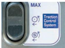
Além desses benefícios, o esforço máximo de tração pode ser ajustado em três estágios (apenas 1 estágio em máquinas convencionais) quando o interruptor de controle de tração está ativado. Isso permite ao operador selecionar o esforço de tração ideal para as mais variadas condições de terreno.
