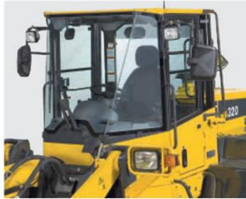
Um amplo vidro de superfície plana e sem colunas proporciona excelente visibilidade frontal. O braço do limpador cobre uma área extensa, possibilitando boa visibilidade até mesmo em dias chuvosos. A ampla área da cabina garante o máximo de conforto para o operador.
